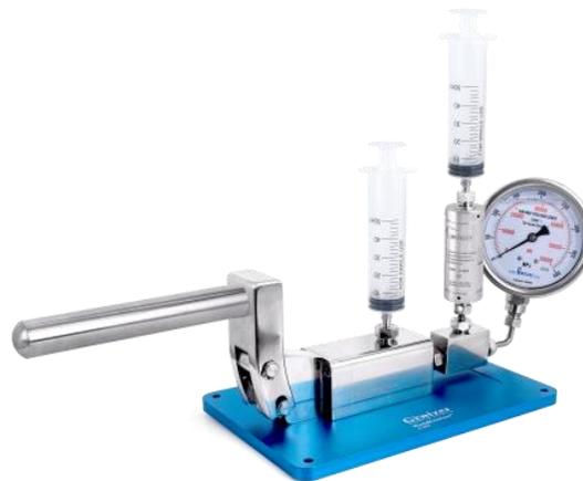
油圧、または空圧式の液体処理装置と比較し、手動式ホモジナイザーは環境にも予算にも優しいミニホモジナイザーです。手動式ホモジナイザーはハンドルを上下移動することで、サンプルに高圧を生成します。また、PLC コントロールシステム、電力を必要せず、特に少量の液状ナノエマルジョンを扱うような簡単な実験作業には理想的です。
